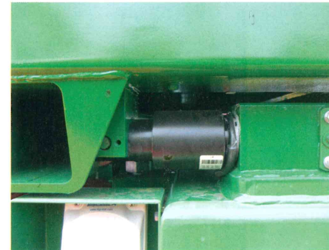
Die Wiegeeinrichtung gewährleistet jederzeit gleichmäßige Streumengen
