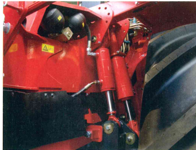
Die Vorderachsenfederung sorgt für hohen und sicheren Fahrkomfort
