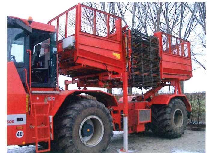
Mit dem HOLMER Schnellwechselsystem sind alle Aufbauten in 30 Minuten auf- und abgebaut
