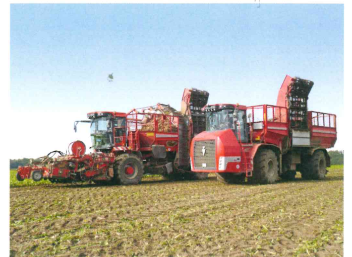
Der Rübenbunker fasst jetzt 36 m 3
