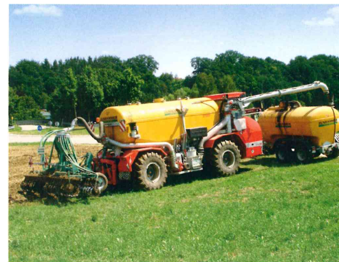
Der 21-m 3 -Tank ist in weniger als drei Minuten befüllt
