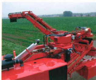
Wypożyczony w 2 wieńce obrotowe przenośnik, wraz z taśmą przeładunkową wychyla się na prawo bądź lewo do 300°
