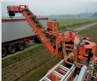
Le bras de chargement peut pivoter à droite ou à gauche dans un rayon d'action de 300° via deux couronnes entraînées hydrauliquement.
